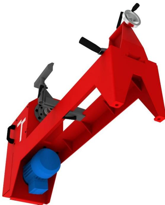
Obr. 27: Pohled na žebrování v loži
