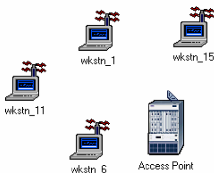
Obr. 2: Příklad zapojení sítě s přístupovým bodem BSS
