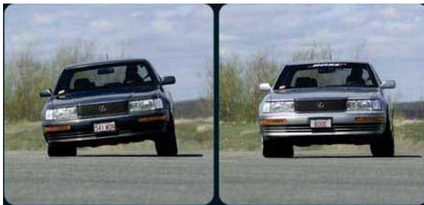
Obr. 3.10 Porovnání bočního náklonu vozu se systémem MRC Bose (vpravo) a běžného odpružení (vlevo). [8]
