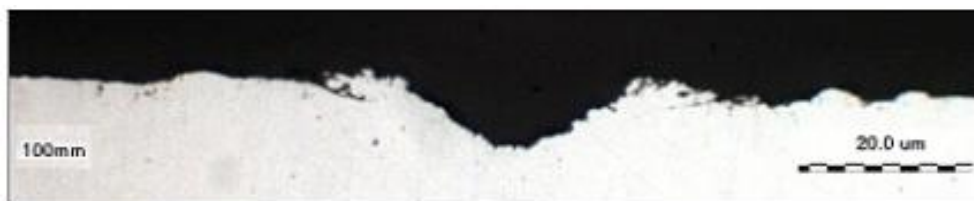
Obr.12 Profil odpařené vrstvy oceli válcované za studena [14]
