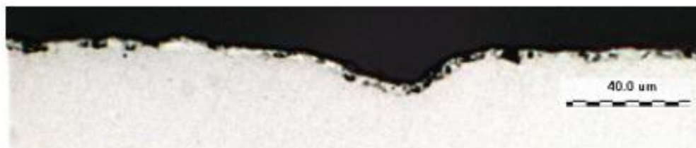
Obr.13 Profil odleptané vrstvy oceli válcované za studena [14]
