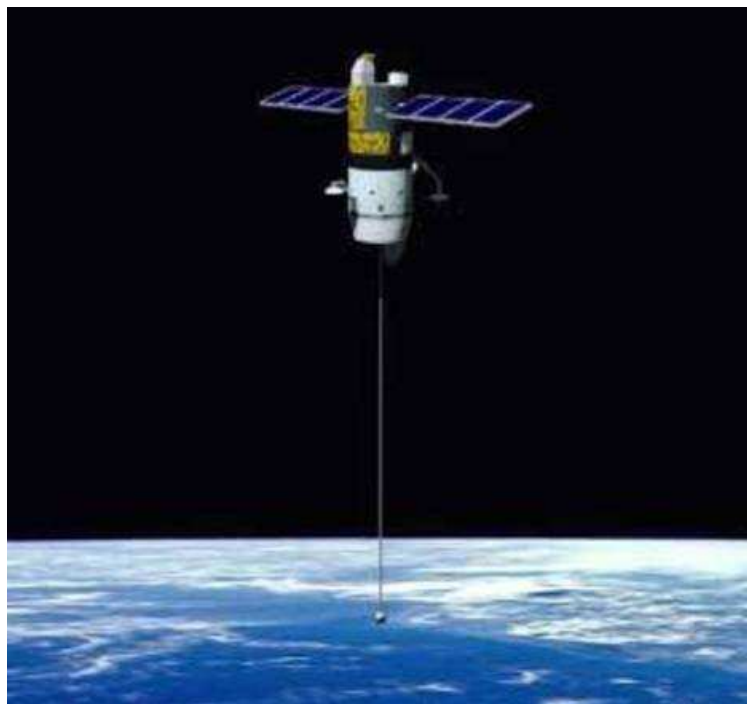
Obrázek 12: Elektromagnetický tether, www.sciencemaster.com
