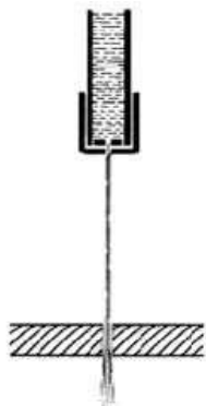
Obr. 1.2 - Řezání čistou vodou 3
