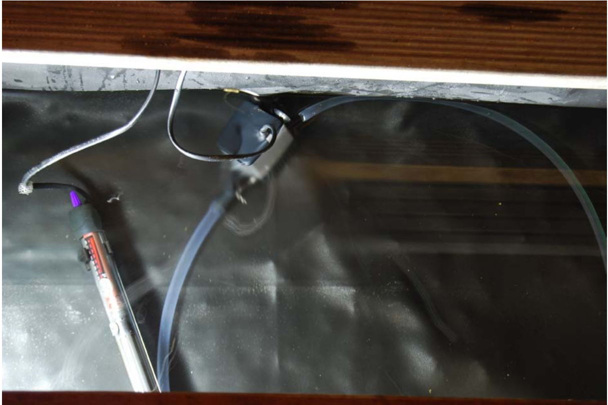
nádoba, voda, akvariijní čerpadlo, topné těleso
