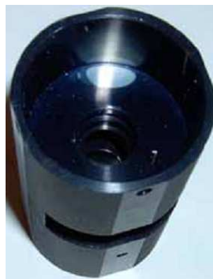
Obr. 16 Nevhodné uchycení v lázni – Bublina [2]
