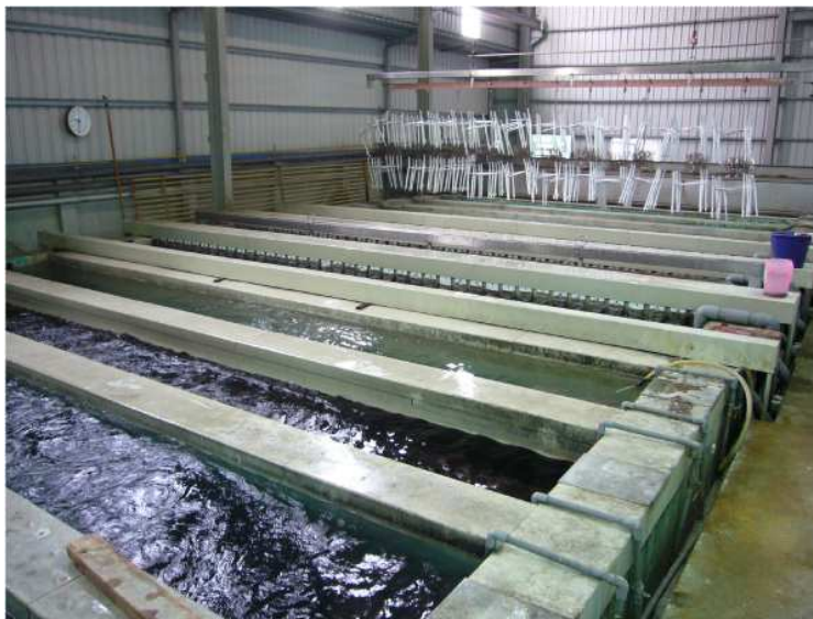
Obr. 13 Ukázka provozu pro eloxování
