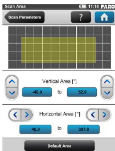
Obr. 19: Nastavenie rozsahu skenovania [4]
