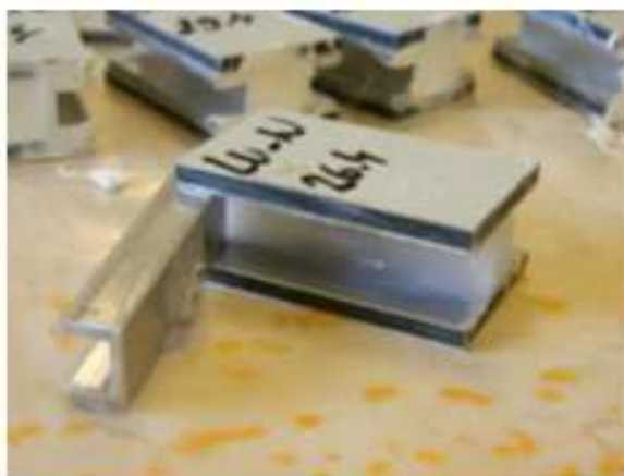
Obrázek 5 Tmel je ve středu stále "živý", při odbedňování došlo k roztržení tmelu
