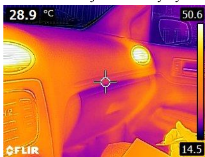
Obrázok 1: Termogram palubnej dosky cca 18 minút po spustení klimatizácie a modelovaný automobil
