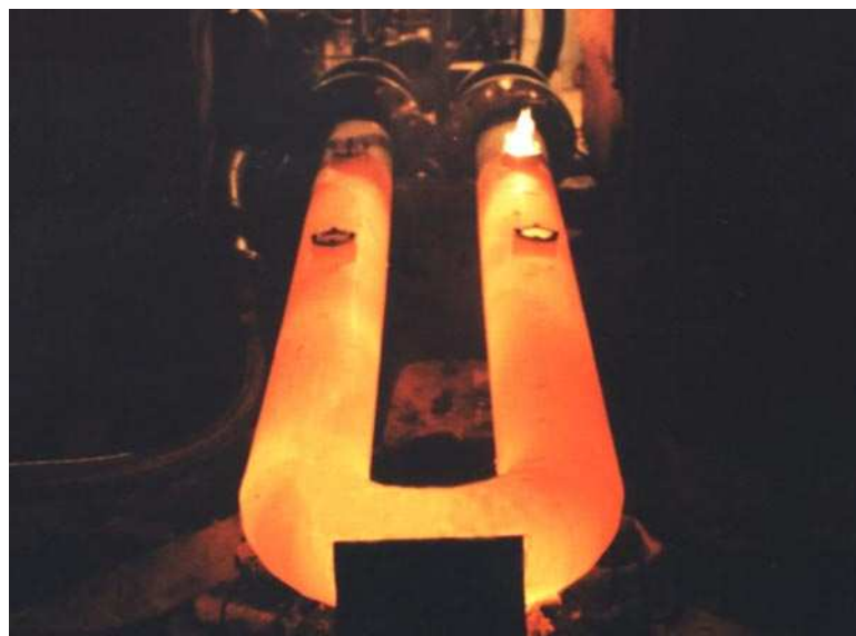
Obr. 5 Sálavý potrubní hořák v praxi [27].
