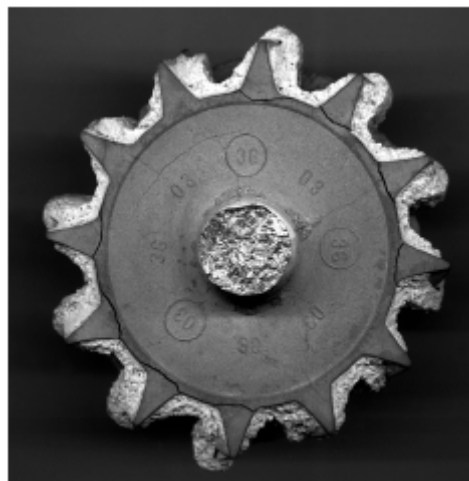
Obr.3.15 Praskliny v TiAl odlitku oběžného kola turbodmychadla, které jsou důsledkem růstu napětí v soustavě odlitek – forma během chlazení na pokojovou teplotu [34]
