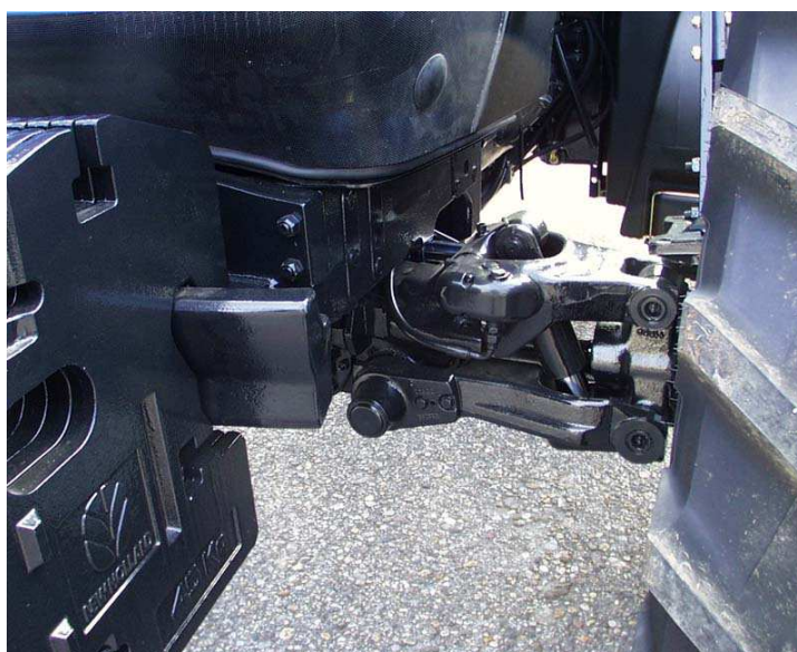
Obr. 8 Nezávisle odpružená přední náprava [20]
