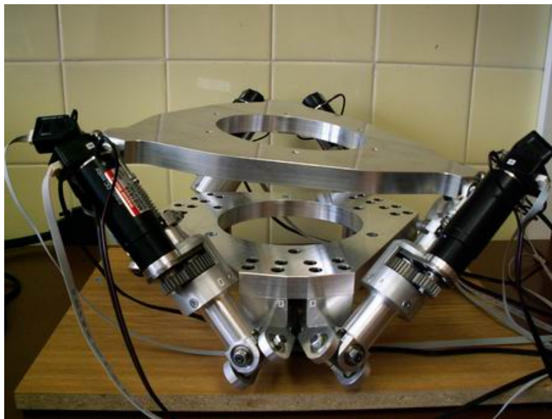
Obr.6 Stewartova platforma zkonstruovaná na Fakultě strojního inženýrství.
