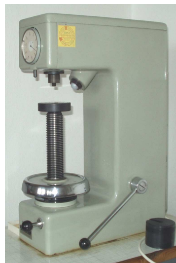
Obr. 1.5 Tvrdoměr Rockwell, 20-88 HRA 6 a starší typ tvrdoměru 2
