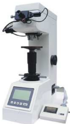
Obr. 1.7 Digitální tvrdoměr Vickers 50kg 6 a starší typ tvrdoměru 2
