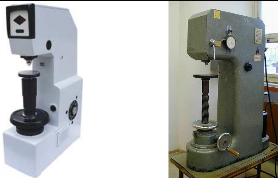
Obr. 1.3 Tvrdoměr Brinell, 8-450 HBS o a starší typ tvrdoměru 2
