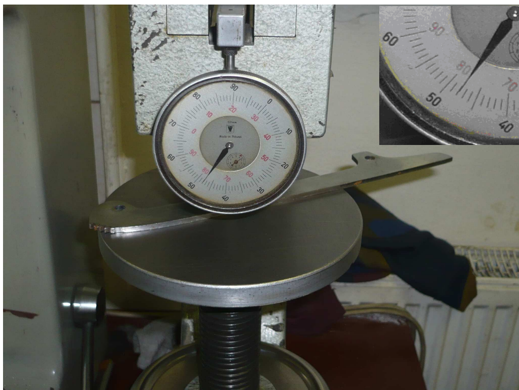
Obr. 3.1 Ukázka z měření tvrdosti nože brusle
