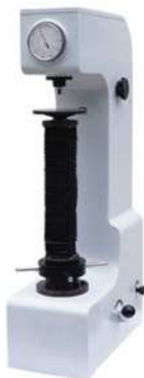
Obr. 1.5 Tvrdoměr Rockwell, 20-88 HRA 6 a starší typ tvrdoměru 2
