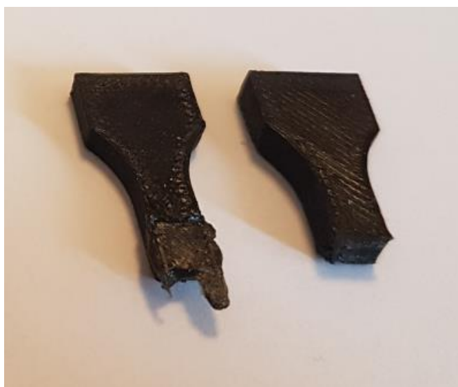
Obr. 11 Vzorky po zatížení na smyk, kde nedošlo ke slepení lepidlem Novafix.
