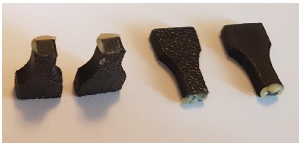
Obr. 13 Vzorky po zatížení na tah s lomem lepidla Novatit.
