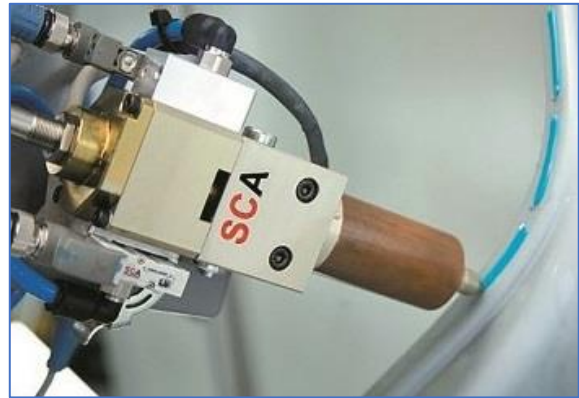
Obr. 13 Nanášanie lepidla na karosériu [19]
