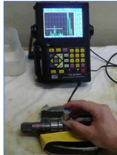
Obr. 66 Skúška ultrazvukom Odrazová [169]
