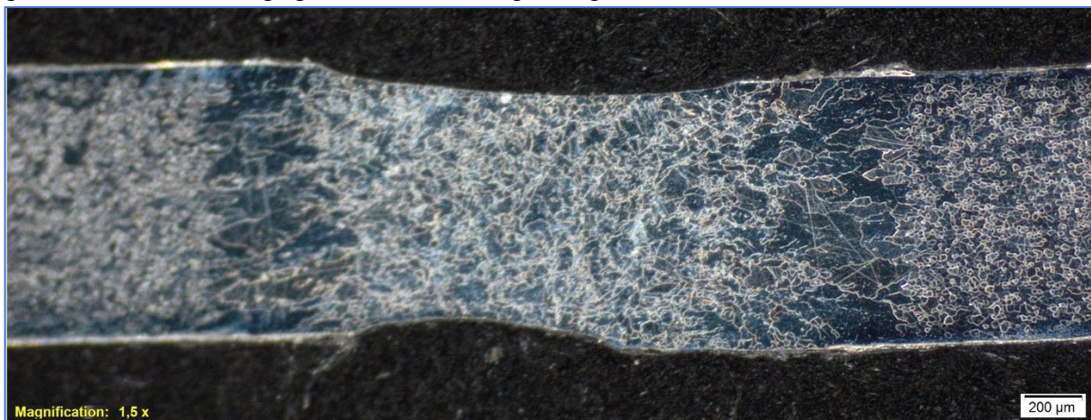
Obr. 96 Snímka makroštruktúry zvarového spoja 2_TS (Laser-TIG; I=20 A)
