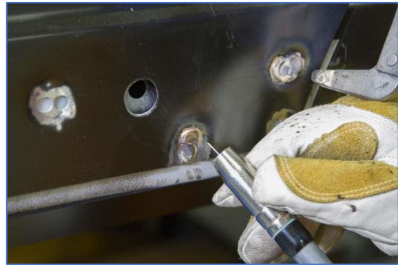
Obr. 11 Spájkovanie metódou MIG B-stĺpika vozidla Honda Accord [146]
