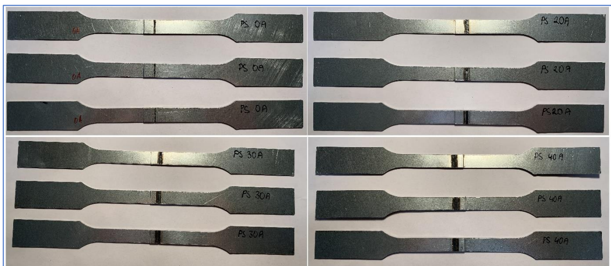
Obr. 76 Laserom vyrezané skúšobné telesa (tyče) pre ťahovú skúšku – Preplátavaný zvar
