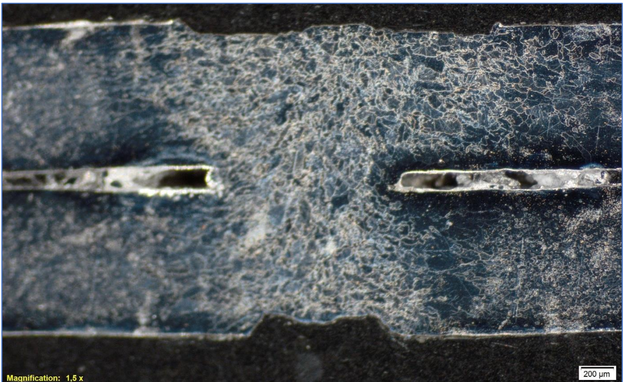
Obr. 94 Snímka makroštruktúry zvarového spoja 4_PS (Laser-TIG I=40 A)
