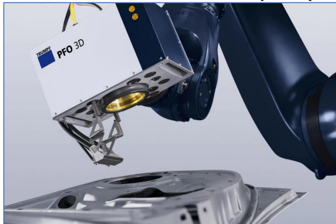
Obr. 16 Skenerové zváranie laserom [147]
