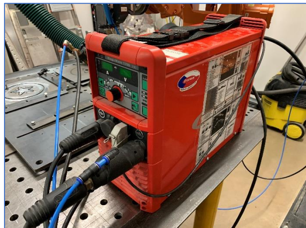
Obr. 71 Zvärací zdroj MagicWave 1700 Job s pripojeným diaľkovým ovládaním na ÚPT AVČR
