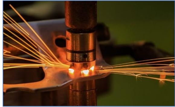
Obr. 5 Odporové bodové zváranie [142]
