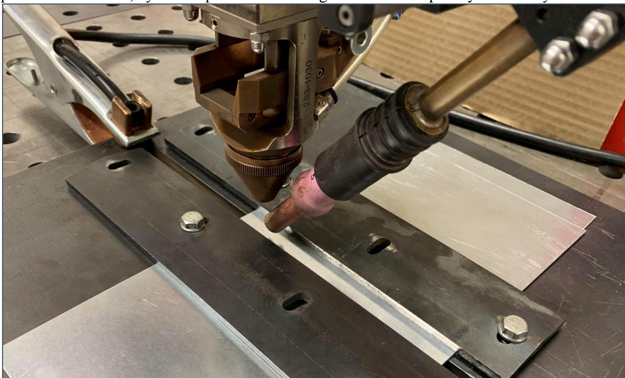
Obr. 1 Zváracia zostava Laser-TIG s predpripravenými plechmi k zvareniu na ÚPT
