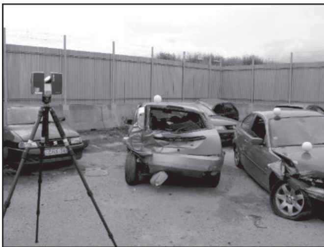
Obr. 1 Měření deformace vozidla Ford Focus. Fig. 1 Deformation measurement of vehicle Ford Focus.
