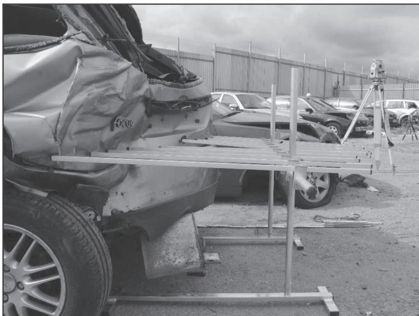
Obr. 6 Měření deformace za pomoci měřicích tyčinek. Fig. 6 Deformation measurement – crush jigs.
