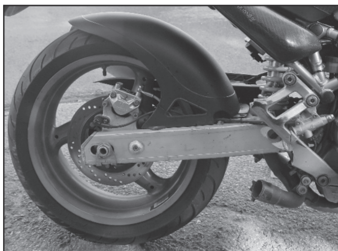
Obr. 6 Poškození pravého boku motocyklu, chybějící stupačka s pedálem zadní brzdy, prasklý držák výfuku, chybějící výfuk (zdroj: PČR).
