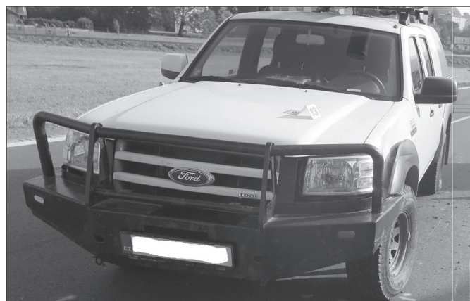
Obr. 1 Ochranný rám na vozidle (zdroj: PČR). Fig. 1 Protective frame in the vehicle (source: police).
