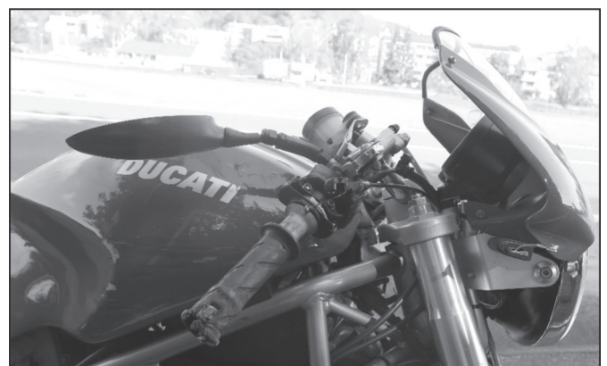
Obr. 5 Poškození pravé strany řídítek, chybí páčka přední brzdy (zdroj: PČR).
