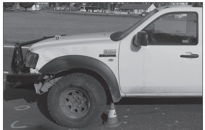
Obr. 4 Poškození levé přední části vozidla (zdroj: PČR). Fig. 4 Damage of the front left part of the vehicle (source: police).
