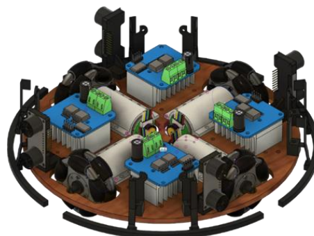
Obrázok 2: Simulácia rozloženia hmotnosti robota cez držiaky motorov
