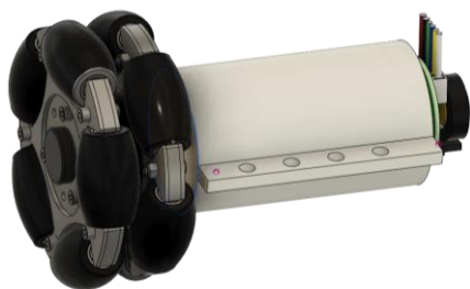
Obrázok 1: Sústava motora, držiaka, kolesa
