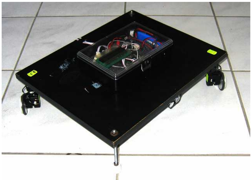
Obr. 3.3 – Realizovaný návrh všesměrového podvozku
