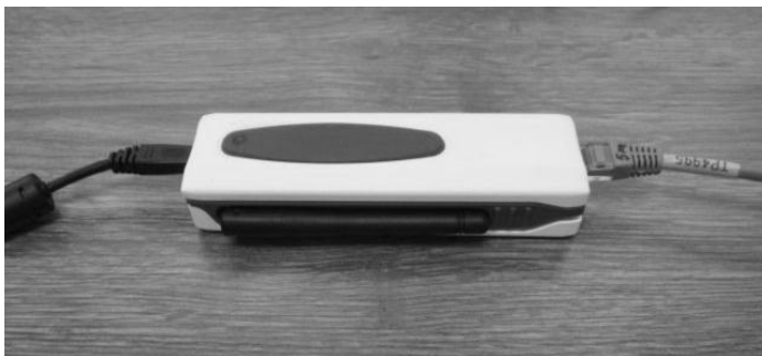
Obr. 3.1: Pouzdro počítače Gumstix Verdex vyvinuté na zakázku pro potřeby řešení projektu
