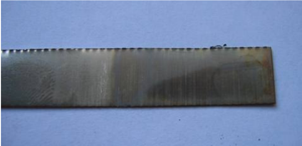
Obr 9: Nanesená vrstva oxidu niklu na Ni elektrodě
