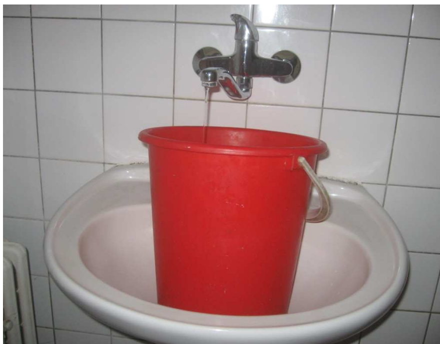
Obr. 4.13: Zachytávání měřené vody do nádob [17]
