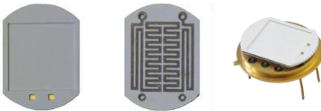
Obrázek 3.2: Pohled na zhotovenou LTCC podložku s heaterem z horní a spodní strany včetně realizace na pouzdře TO-8
