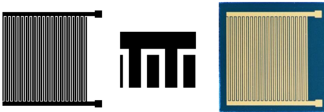
Obrázek 3.7: Celkový návrh, detail návrhu a zhotovený substrát s interdigitální strukturou
