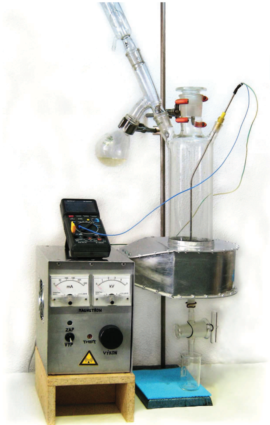
Obr. 20. Aparatura s mikrovlnným ohřevem použita k ověření možnosti zkapalnění PU a PIR pěn působením glycerolu
