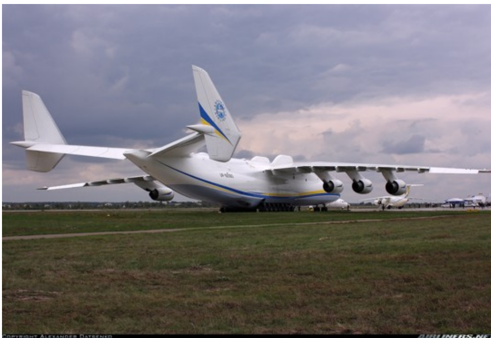
Obr. 14 Zdvojená SOP letounu Antonov An-225 je typická pro stroje určené k přepravě nákladu na hřbetě
