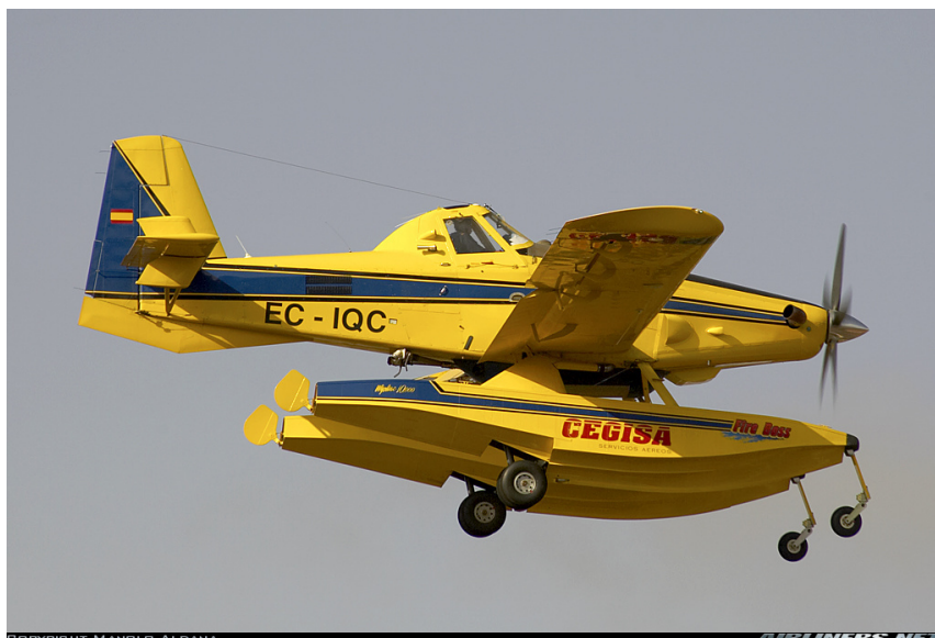
Obr. 35 Obojživelné přistávací zařízení na letounu AT-802A
