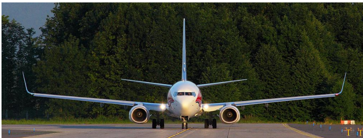
Obr. 5 Čelní pohled na Boeing 737-800; pozorujeme kruhový průřez trupu, kladné vzepětí křídla i VOP, vzájemnou polohu motorů a podvozkových noh, resp. křídla a VOP, dále porovnání rozměrů trupu, podvozku, křídla, wingletů a ocasních ploch
