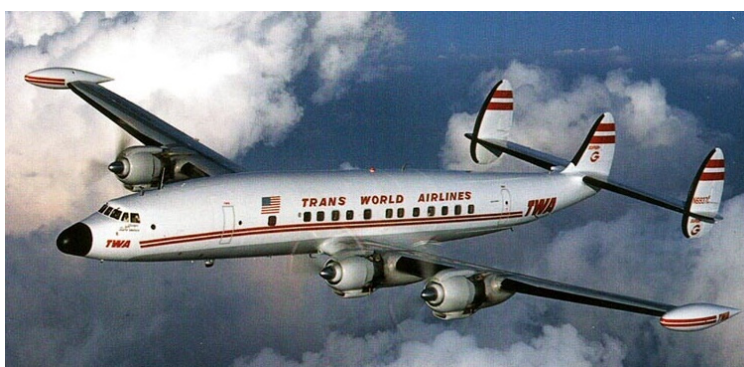
Obr. 10 Lockheed L-049 Constellation, nositel trojité svíslé ocasní plochy
