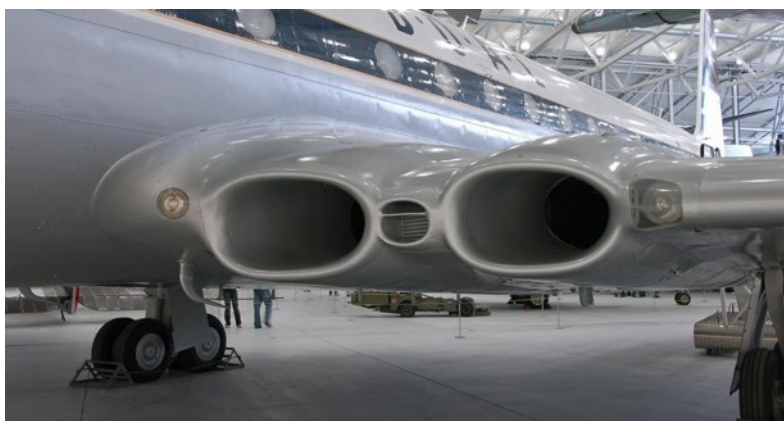
Obr. 6 Umístění motorů letounu de Havilland DH 106 Comet
