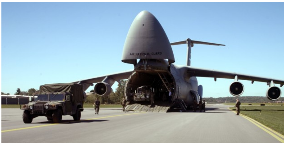
Obr. 13 Lockheed C-5A Galaxy, probíhá nakládka, před' i zád' jsou otevřeny, pozorujeme výrazné záporné vzepětí a ocasní plochy uspořádané do T
