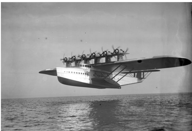
Obr. 32 Dornier Do X, v době svého vzniku největší létající člun světa; pozorujeme motory na pylonech na horní ploše křídla, kromě toho se jedná o sesquiplán – kompromis mezi jedno- a dvojplošníkem – u nějž je navíc dolního křídla využito jako stabilizačního plováku
