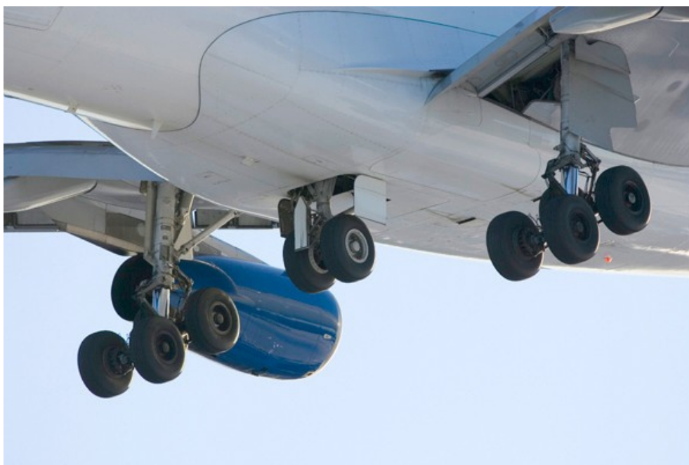
Obr. 8 Uspořádání hlavních podvozkových noh stroje Airbus A340
