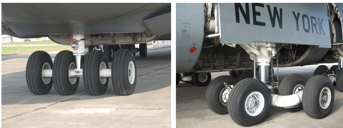
Obr. 15, Obr. 16 Detaily přistávacího zařízení letounu Lockheed C-5A
