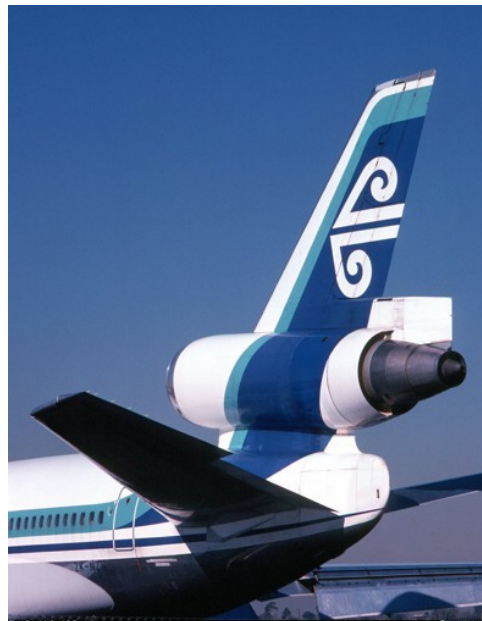
Obr. 7 umístění třetího motoru v kýlu letounu McDonnell Douglas DC-10
