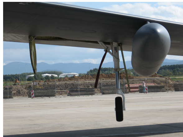
Obr. 17, Obr. 18, Obr. 19 Celková dispozice a detaily tandemového podvozku bombardéru Boeing B-52H
