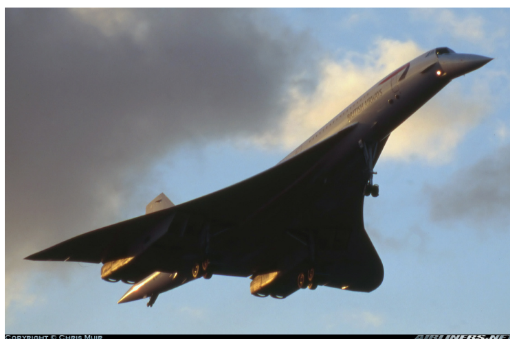
Obr. 9 Aérospatiale-BAC Concorde, na snímku je patrný půdorysný tvar gotického křídla
