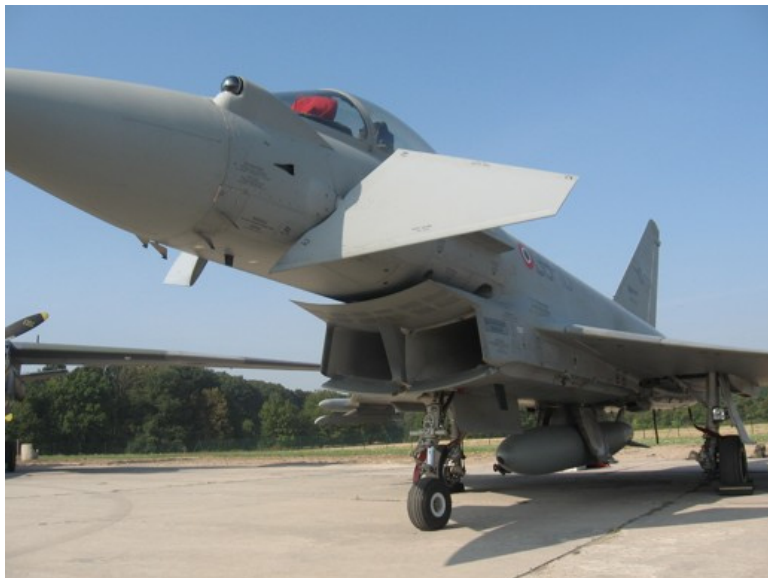
Obr. 39 Eurofighter Typhoon; snímek odhaluje kromě plovoucích kachních ploch také řešení podvozku a vstupů vzduchu k pohonným jednotkám
