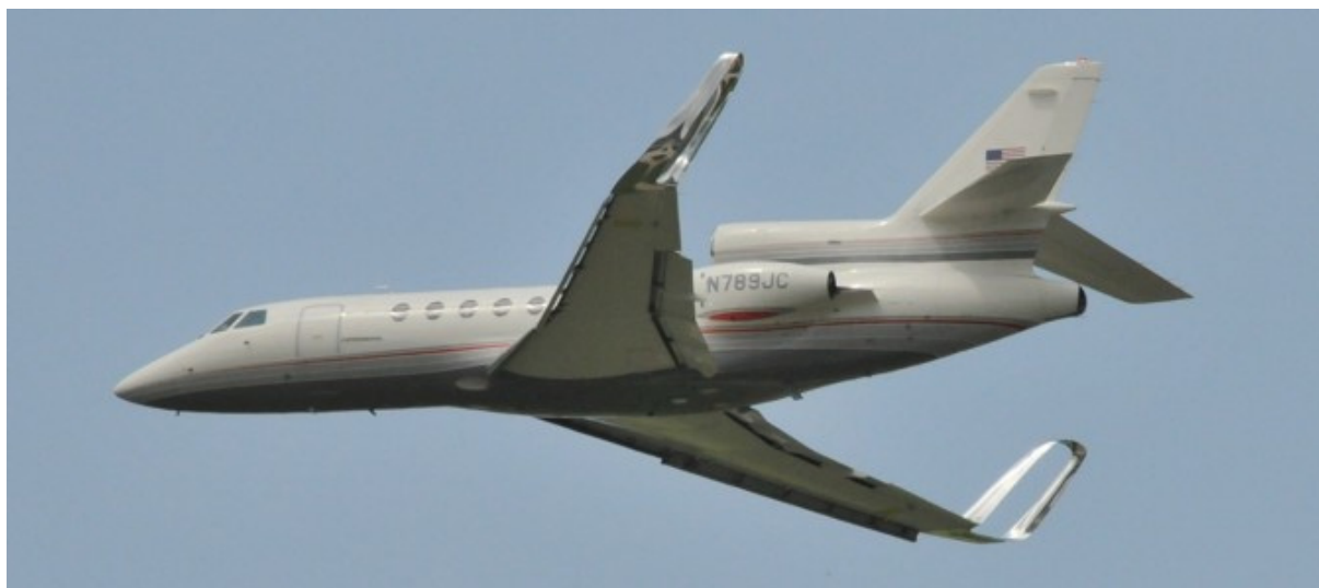
Obr. 22 Spiroid tips instalované na letounu Dassault Falcon 50
