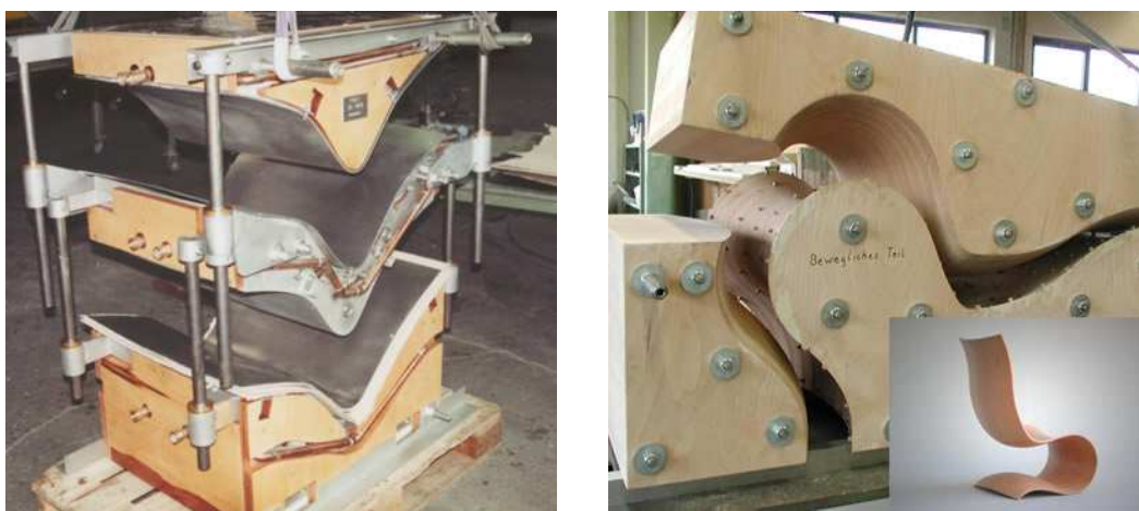
Obr.2.13 Tvarované topné pásy na výrobu tvarových výlisků (14)
