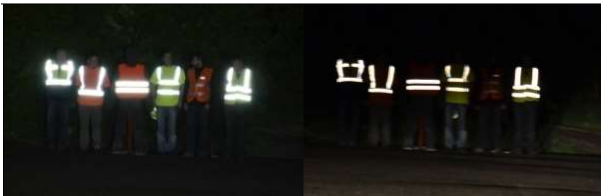
Obr. 5 – Viditelnost bezpečnostních vest – vlevo dálková světla, vpravo tlumená – detail. Fig. 5 – Visibility of safety vests – highbeam on the left, low beam on the right – detail.
