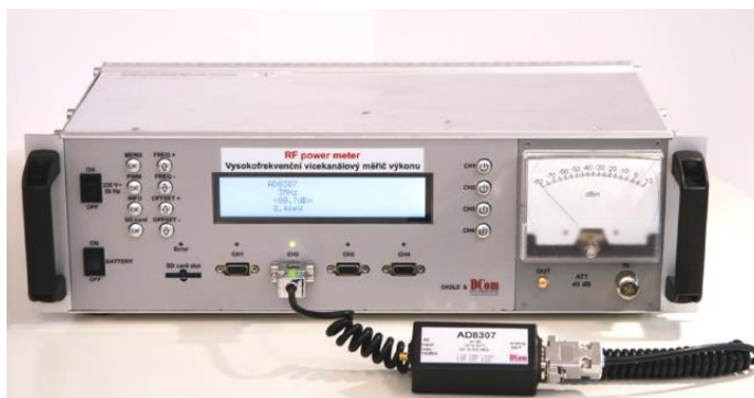
Obrázek 6: Mechanické provedení měřiče včetně připojeného detektoru AD8307
