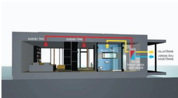
Schéma řízeného větrání s rekuperací tepla.
