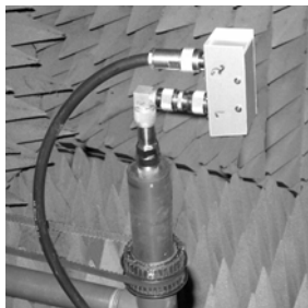
Fig. 4. The T-Network box in situ.
