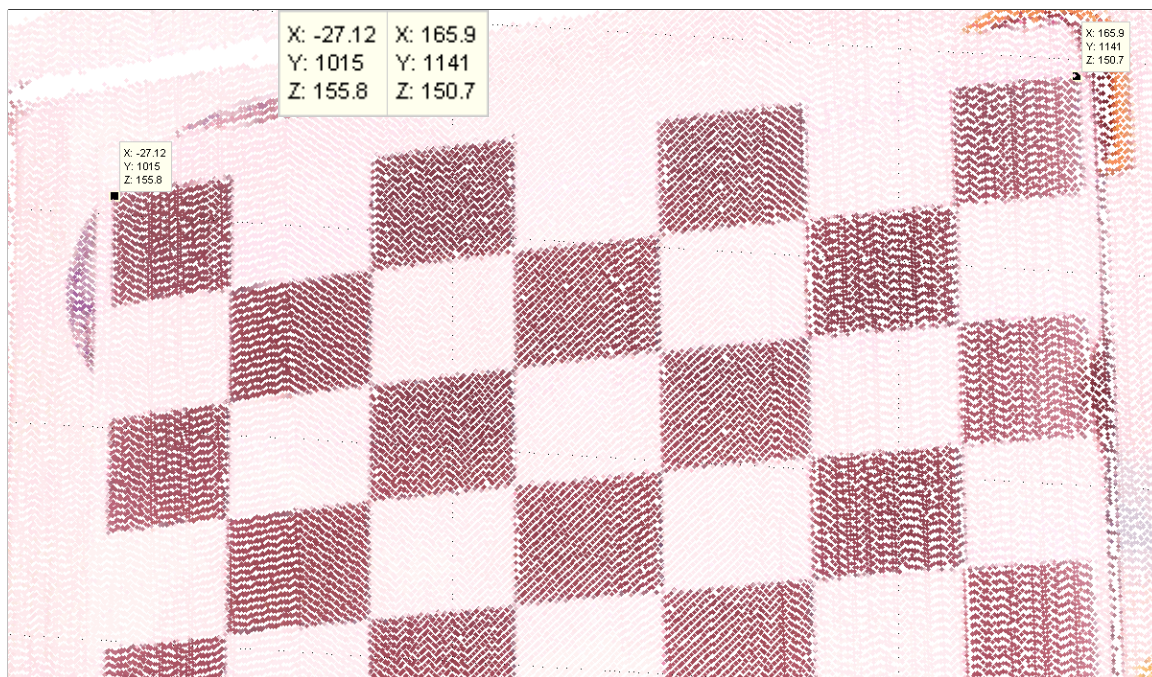
Obrázok 45: Meranie presnosti metódy pre 3D skenovanie
