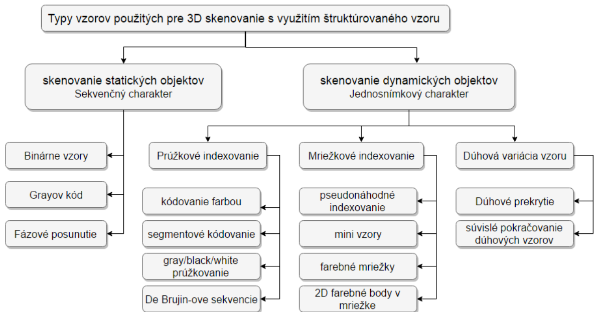
Obrázok 6: Rozdelenie metód pre 3D skenovanie s využitím štruktúrovaného svetla [27]
