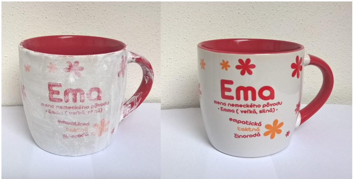
Obrázok 66: Predmet po a pred nanosením práškového náteru
