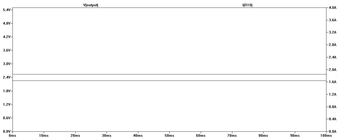
Obr. 14 Výsledek simulace nastavení proudového omezení na minimum
