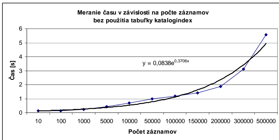
Graf 5.6.1.1: Meranie času v závislosti na počte záznamov bez použitia tabuľky katalogindex
