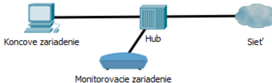
Obrázek 2.3: Monitorovacie zariadenie je pripojené do rozbojva
