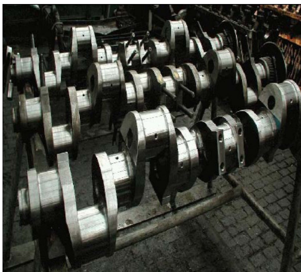
Obr.7: Použití ocelí třídy 16 – klikový hřídel [7]
