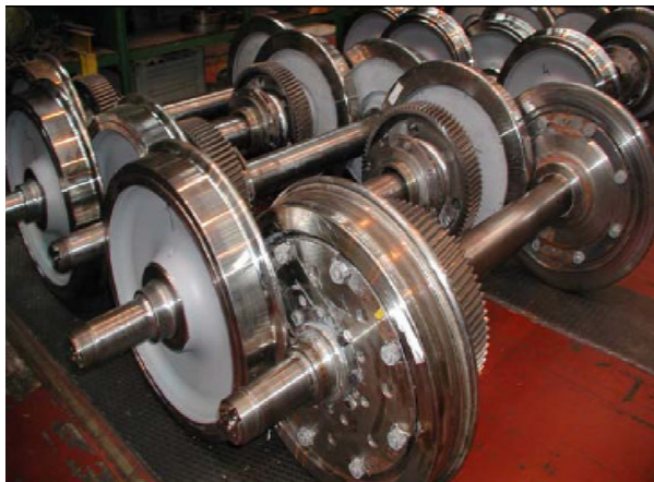
Obr.6: Použití ocelí třídy 12 - podvozky s ozubenými koly [6]
