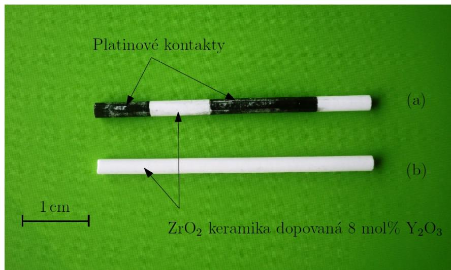
Obr. 6.10: (a) Kapilára s naprášenými kontakty z platiny. (b) Kapilára před naprašováním kontaktů.
