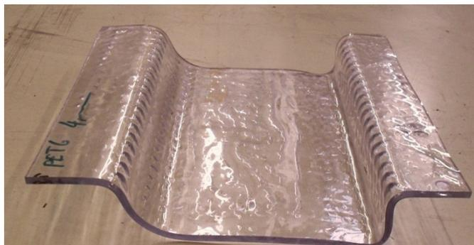
Abb. 6-4 Die Abdrücke an der guten Seite des Formteiles
