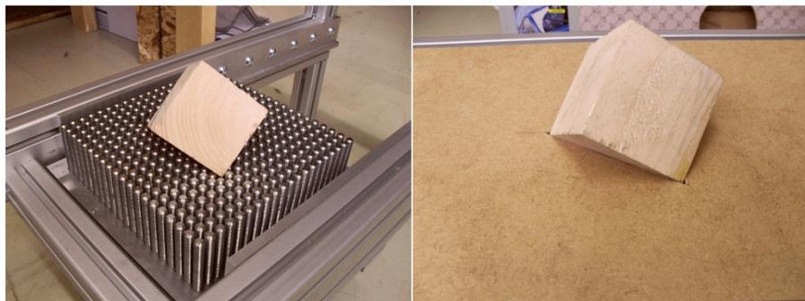
Abb. 6-6 Die Gegenstempeln für den Versuch B und D
