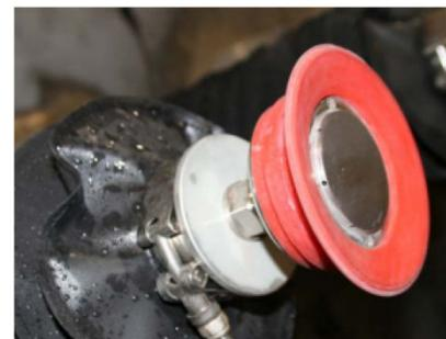
Abb. 3-11 Eine einstellbare Spanneinrichtung für große Teile mit Vakuumschlus [29]
