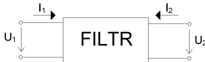
Obr. 1.1: Filtr jako lineární dvojbran
