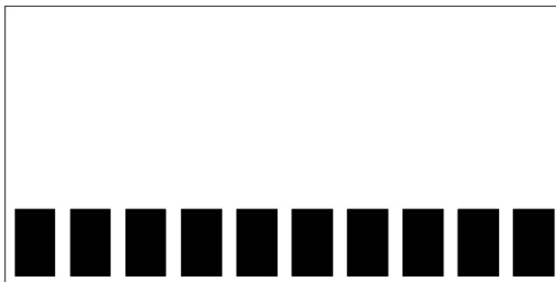
Obr. 3.2. Zadní strana substrátu s ploškami pro připájená vývodových hřebínků
