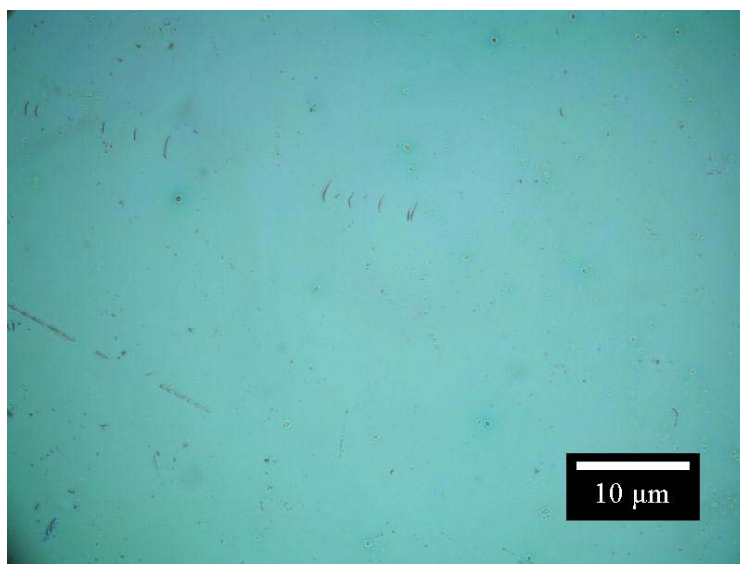
Obr. 7: Mikrofotografie vzorku neodsoleného Pc_{1-2} v kombinaci s vrstvou PCBM při polarizovaném světle
