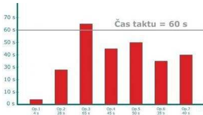
Obrázek 5 Diagram vytížení linky a porovnání s časem taktu
