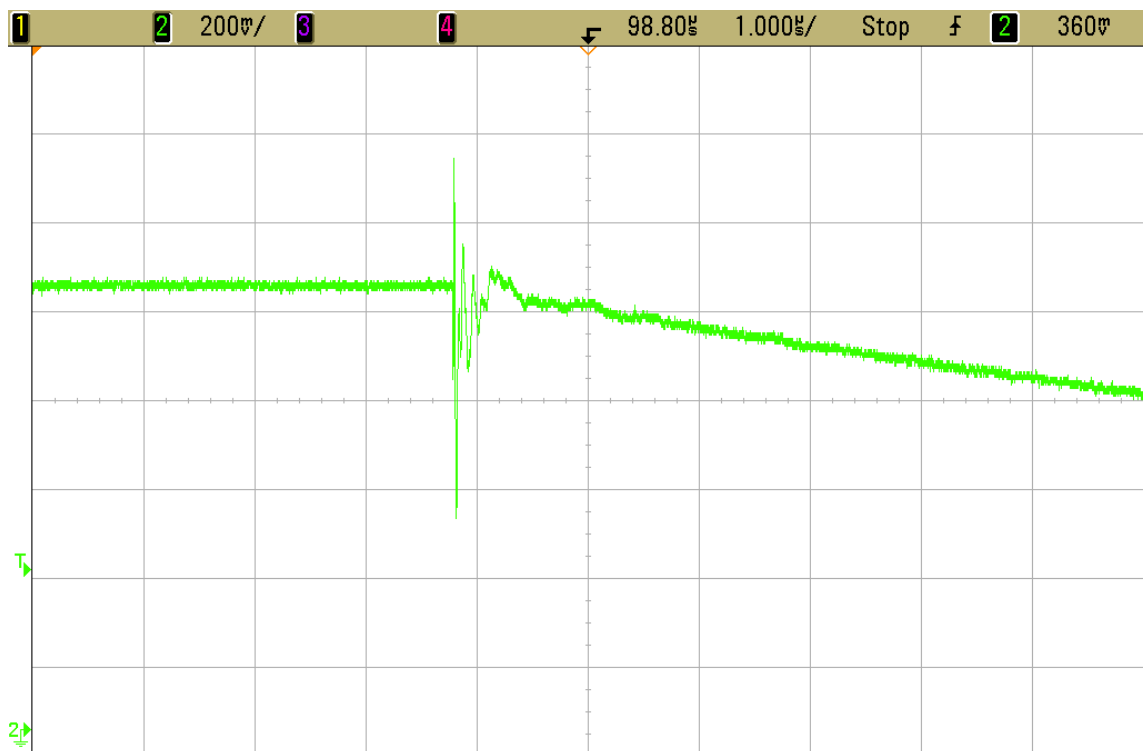
Obrázek 5.15 Odezva na vstupní impuls u tranzistoru BS170 u Vylepšeného Wilsonova proudového zrcadla, sestupná hrana
