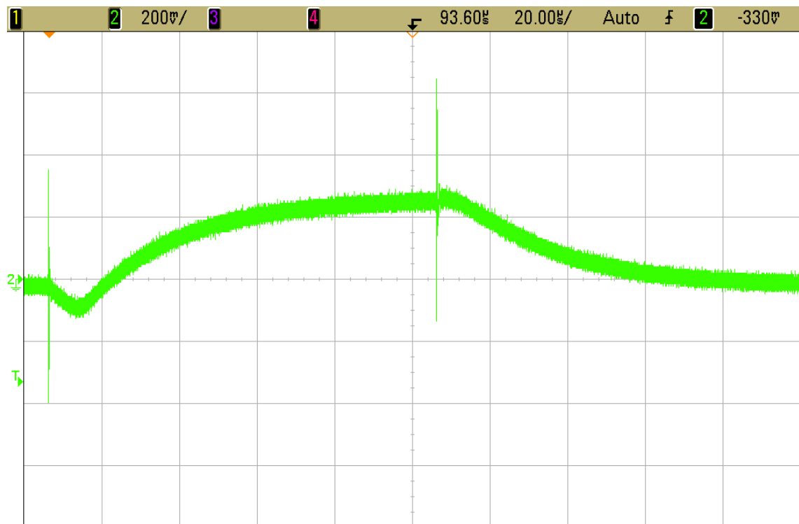
Obrázek 5.22 Odezva na vstupní impuls u tranzistoru IRF740 u Vylepšené Wilsonovo proudového zrcadla
