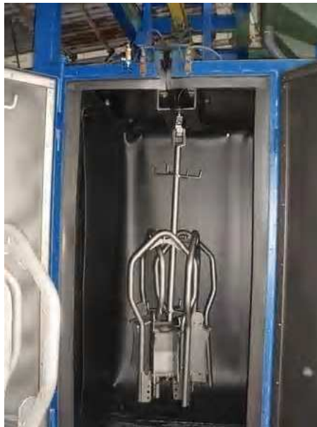
Obr. 3.3. Jeden z možných způsobů fosfátování 5
