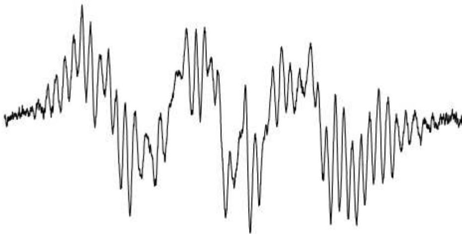
Obr. 6 – Experimentální EPR spektrum pozorované v systému Luperox 531 + NB + CoO v toluenu po čase 10 minut
