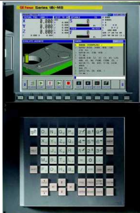
Obr. č. 5 Ovládací panel Fanuc 18i - MB. [8]
