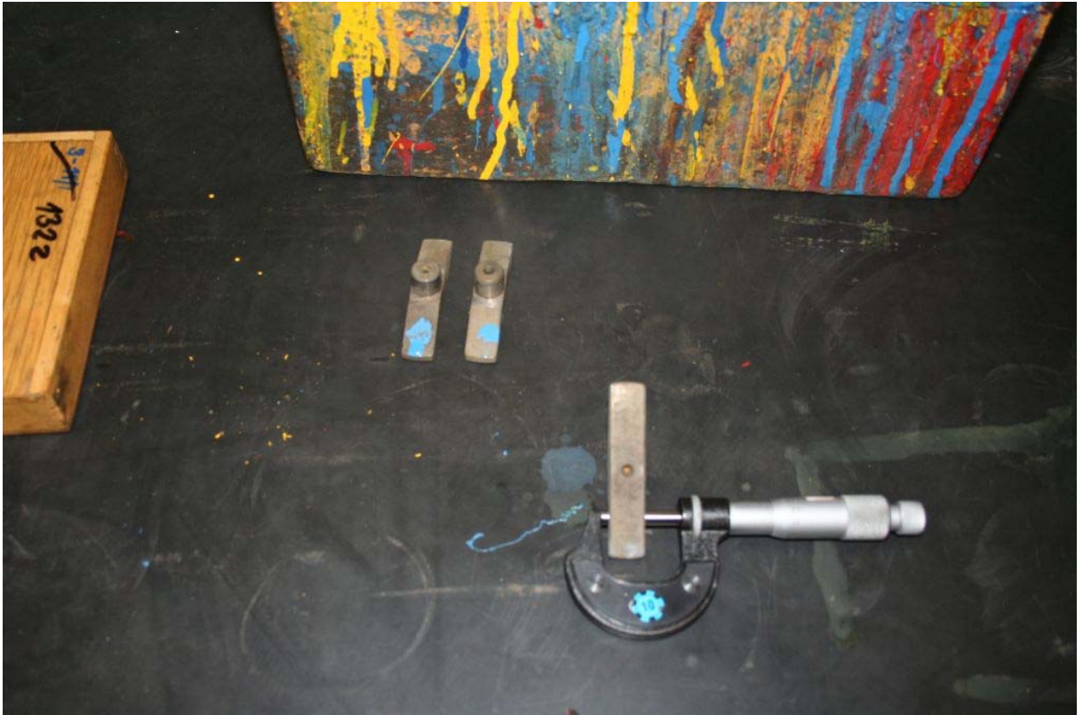
obr.4: Přímá defektace řadícího kamene mikrometrem
