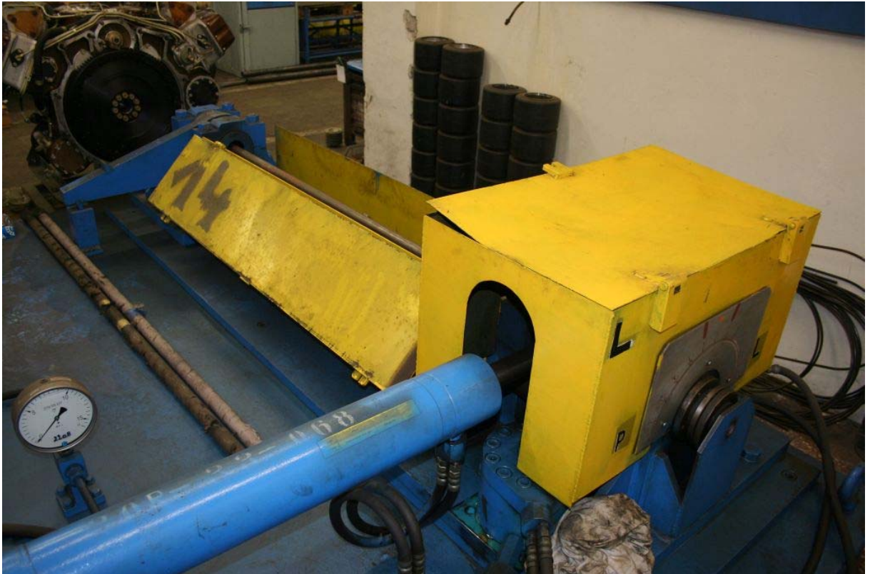
obr.5: Nepřímá defektace torzní tyče na zkušebním zařízení
