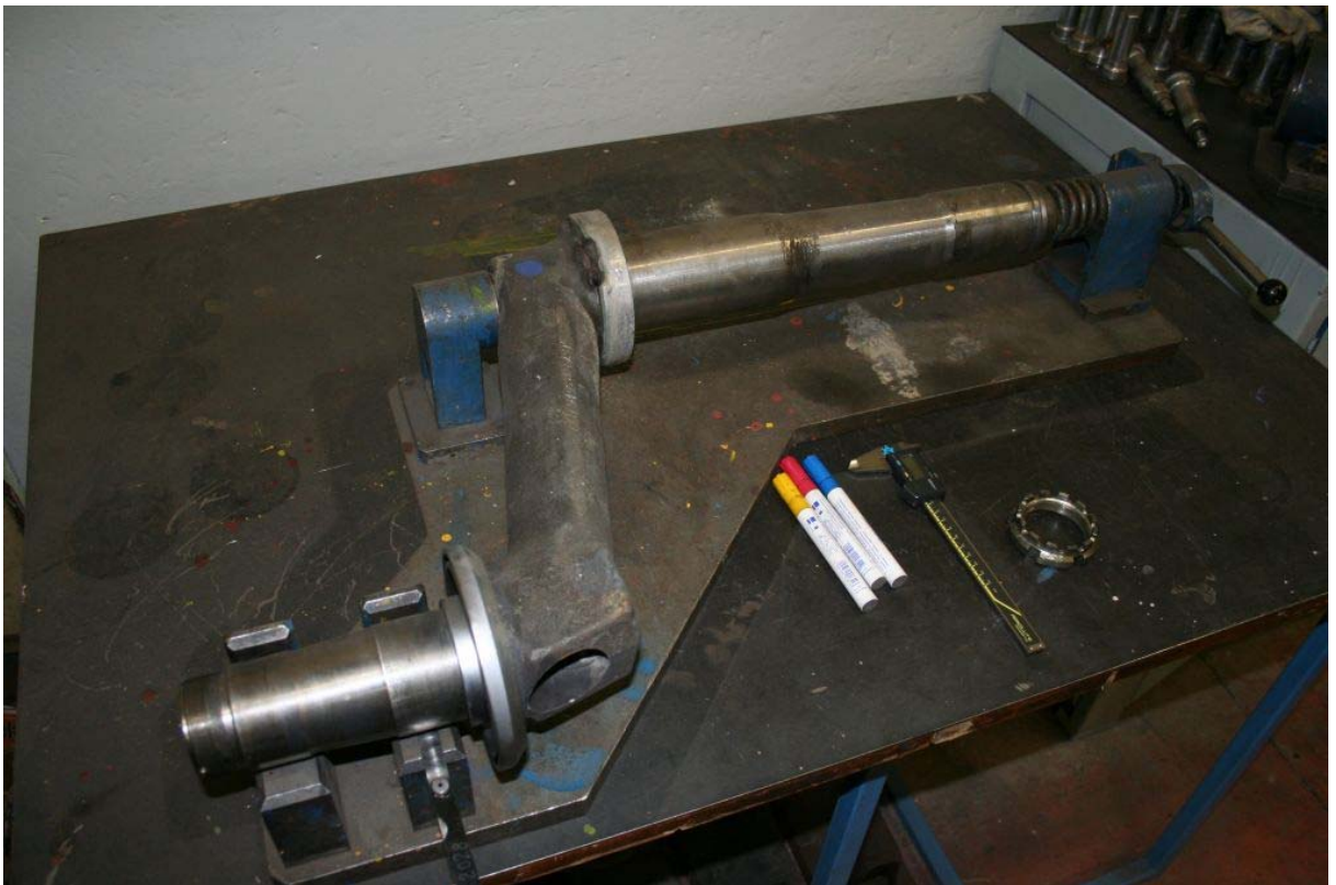
obr.12: Přípravek pro skupinovou defektaci vahadel pojezdových kol
