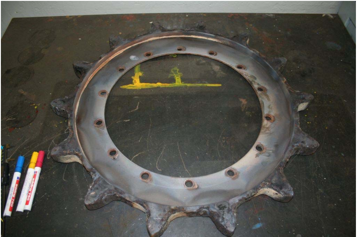
obr.13: Věnec hnacího kola
