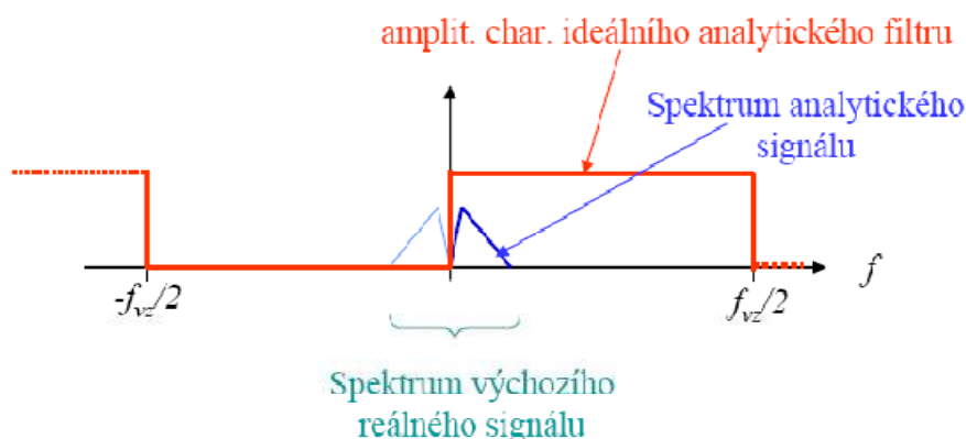
Obrázek 4-2 Amplitudová charakteristika ideálního analytického filtru a spektrum analytického signálu[8]
